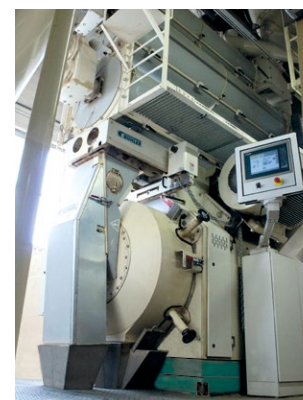
Unsere Press- und Hygienisierungsanlage: Bei der Pelletherstellung tötet sie schädliche Keime und Mikroorganismen ab.
