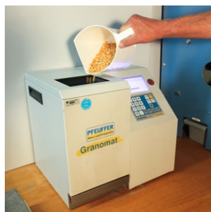
Granomat bei der Bestimmung von Schüttdichte und Feuchtigkeit einer Maispartie
