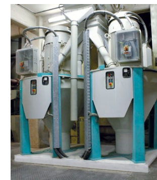
Hier geht's zur Sache: In unserer Vermahlungsanlage werden die Rohwaren entsprechend den Anforderungen grob bis fein gemahlen – Je nachdem, welches Futter gerade produziert werden soll.
