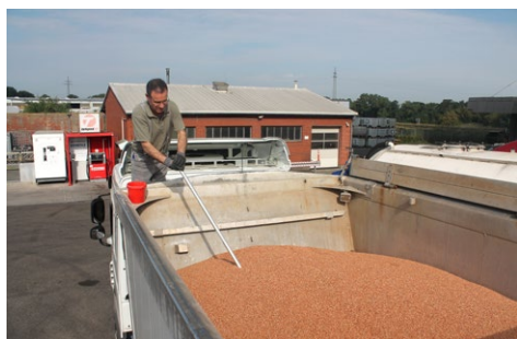
Beprobung einer Rohwarenanlieferung
